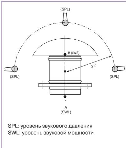
Для определения уровней звуковой мощности в точках А или В, в режиме вытяжки, необходимо, к уровням звукового давления, указанным в таблице с техническими характеристиками, прибавить поправочные коэффициенты, приведенные в следующей таблице:
